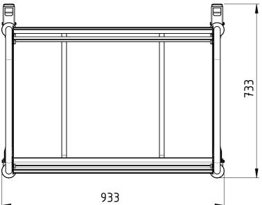
Traglast 500 kg (pro Ladefläche 100 kg), 4x Vollgummi-Lenkrollen (2x mit Totalfeststeller), lackiert RAL 5012 Lichtblau
