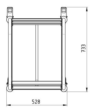
Traglast 500 kg (pro Ladefläche 100 kg), 4x Vollgummi-Lenkrollen (2x mit Totalfeststeller), lackiert RAL 5012 Lichtblau
