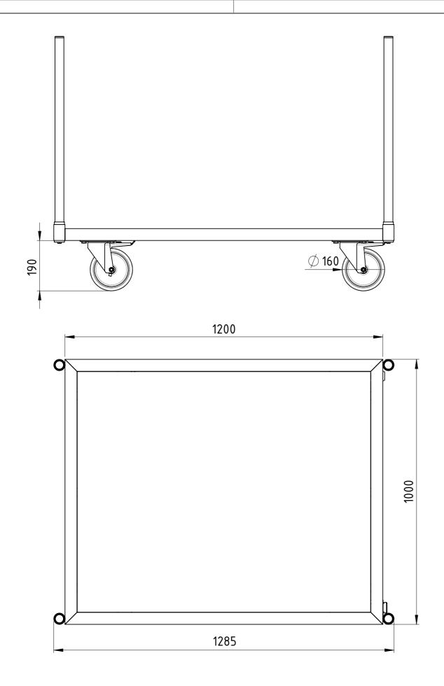
Traglast 1000 kg, 4x Polyurethan-Lenkrollen (2x mit Totalfeststeller), 15 mm filmbeschichtete Multiplexplatte, kunstharzlackiert RAL 5012 Lichtblau
