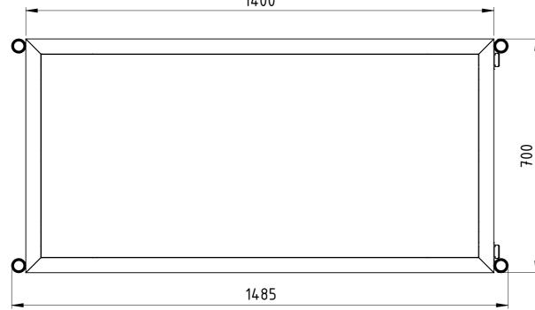
Traglast 1000 kg, 4x Polyurethan-Rollen (2x Bockrollen, 2x Lenkrollen mit Totalfeststeller), 15 mm filmbeschichtete Multiplexplatte, kunstharzlackiert RAL 5012 Lichtblau
