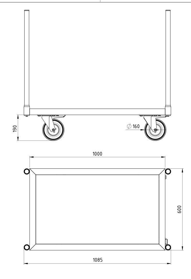
Traglast 500 kg, 4x Vollgummi-Lenkrollen (2x mit Totalfeststeller), 15 mm filmbeschichtete Multiplexplatte, kunstharzlackiert RAL 5012 Lichtblau
