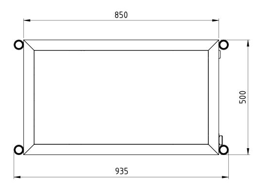
Traglast 1000 kg, 4x Polyurethan-Lenkrollen (2x mit Totalfeststeller), 15 mm filmbeschichtete Multiplexplatte, kunstharzlackiert RAL 5012 Lichtblau
