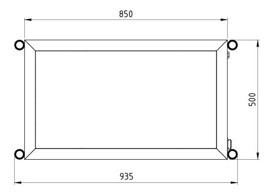
Traglast 500 kg, 4x Vollgummi-Lenkrollen (2x mit Totalfeststeller), 15 mm filmbeschichtete Multiplexplatte, kunstharzlackiert RAL 5012 Lichtblau
