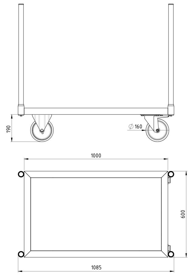
Traglast 1000 kg, 4x Polyurethan-Rollen (2x Bockrollen, 2x Lenkrollen mit Totalfeststeller), 15 mm filmbeschichtete Multiplexplatte, kunstharzlackiert RAL 5012 Lichtblau
