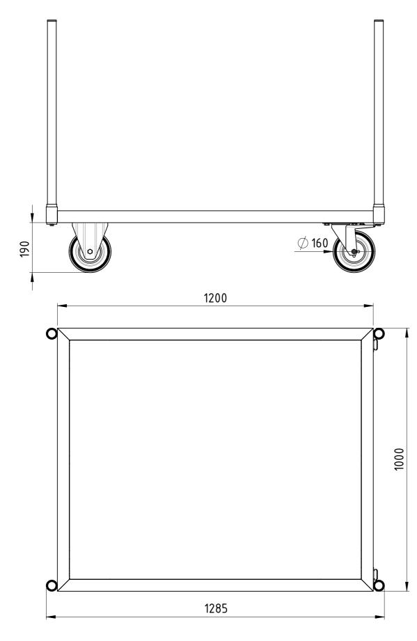
Traglast 500 kg, 4x Vollgummi-Rollen (2x Bockrollen, 2x Lenkrollen mit Totalfeststeller), 15 mm filmbeschichtete Multiplexplatte, kunstharzlackiert RAL 5012 Lichtblau
