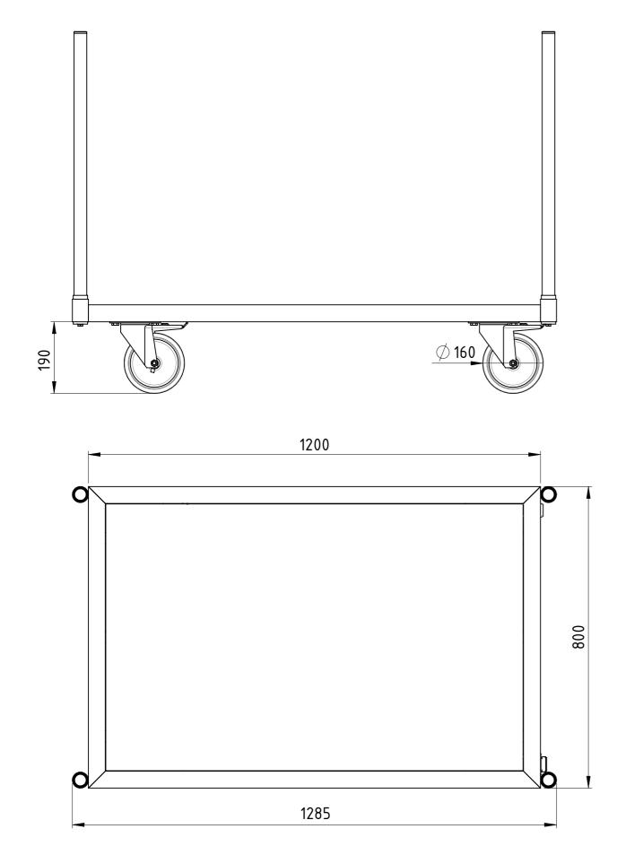
Traglast 1000 kg, 4x Polyurethan-Lenkrollen (2x mit Totalfeststeller), 15 mm filmbeschichtete Multiplexplatte, kunstharzlackiert RAL 5012 Lichtblau
