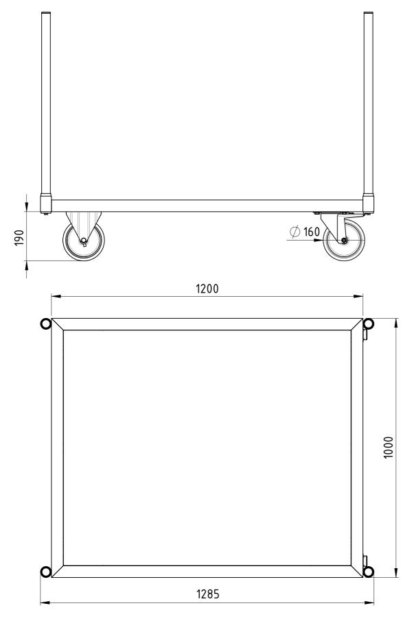
Traglast 1000 kg, 4x Polyurethan-Rollen (2x Bockrollen, 2x Lenkrollen mit Totalfeststeller), 15 mm filmbeschichtete Multiplexplatte, kunstharzlackiert RAL 5012 Lichtblau
