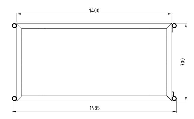
Traglast 1000 kg, 4x Polyurethan-Lenkrollen (2x mit Totalfeststeller), 15 mm filmbeschichtete Multiplexplatte, kunstharzlackiert RAL 5012 Lichtblau
