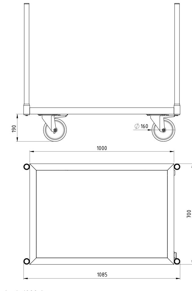
Traglast 1000 kg, 4x Polyurethan-Lenkrollen (2x mit Totalfeststeller), 15 mm filmbeschichtete Multiplexplatte, kunstharzlackiert RAL 5012 Lichtblau
