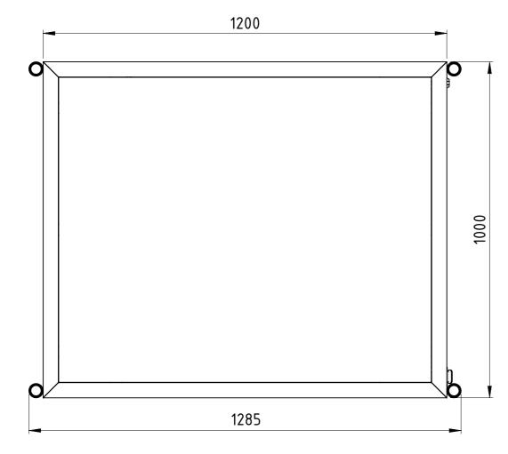
Traglast 500 kg, 4x Vollgummi-Lenkrollen (2x mit Totalfeststeller), 15 mm filmbeschichtete Multiplexplatte, kunstharzlackiert RAL 5012 Lichtblau
