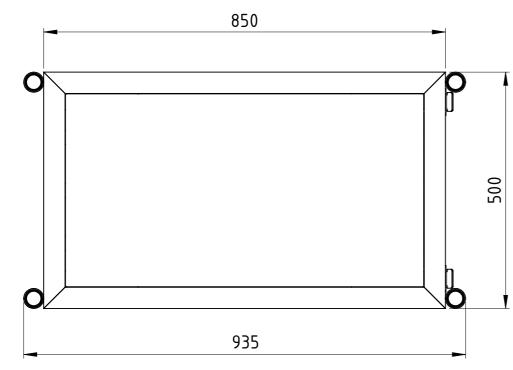
Traglast 1000 kg, 4x Polyurethan-Rollen (2x Bockrollen, 2x Lenkrollen mit Totalfeststeller), 15 mm filmbeschichtete Multiplexplatte, kunstharzlackiert RAL 5012 Lichtblau
