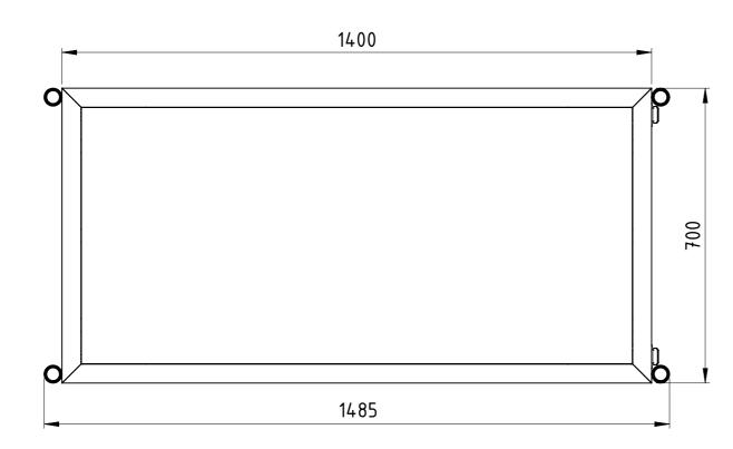
Traglast 500 kg, 4x Vollgummi-Rollen (2x Bockrollen, 2x Lenkrollen mit Totalfeststeller), 15 mm filmbeschichtete Multiplexplatte, kunstharzlackiert RAL 5012 Lichtblau
