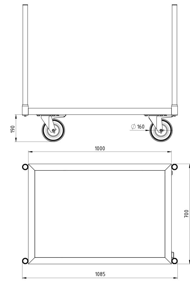
Traglast 500 kg, 4x Vollgummi-Lenkrollen (2x mit Totalfeststeller), 15 mm filmbeschichtete Multiplexplatte, kunstharzlackiert RAL 5012 Lichtblau
