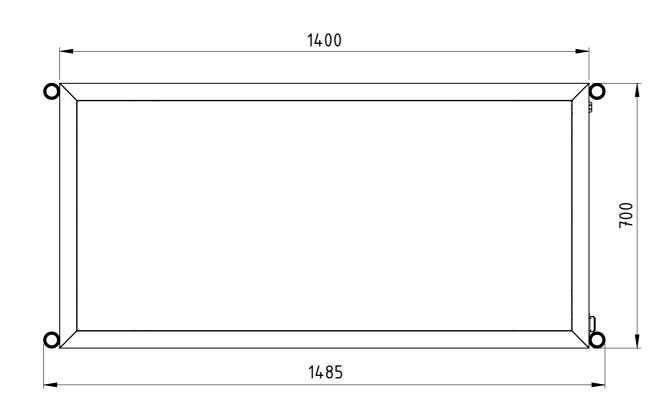
Traglast 500 kg, 4x Vollgummi-Lenkrollen (2x mit Totalfeststeller), 15 mm filmbeschichtete Multiplexplatte, kunstharzlackiert RAL 5012 Lichtblau
