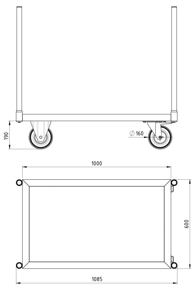
Traglast 500 kg, 4x Vollgummi-Rollen (2x Bockrollen, 2x Lenkrollen mit Totalfeststeller), 15 mm filmbeschichtete Multiplexplatte, kunstharzlackiert RAL 5012 Lichtblau
