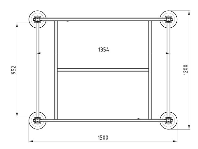
Traglast 600 kg, Auflast 1200 kg, lackiert RAL 5012 Lichtblau
