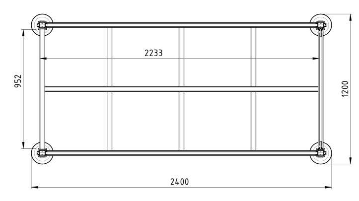
Traglast 600 kg, Auflast 1200 kg, lackiert RAL 5012 Lichtblau
