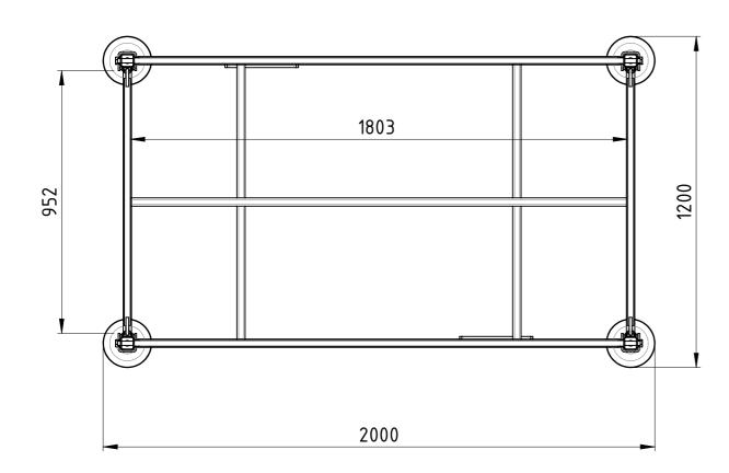
Traglast 600 kg, Auflast1200 kg, lackiert RAL 5012 Lichtblau
