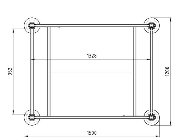
Traglast 600 kg, Auflast 1200 kg, lackiert RAL 5012 Lichtblau
