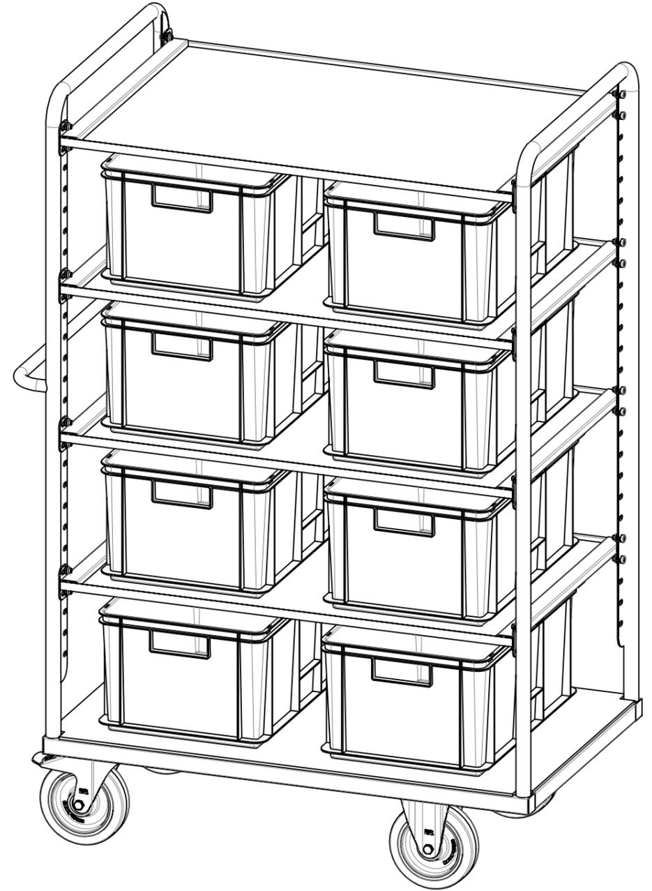
Traglast 1000 kg (pro Einhängboden 200 kg, unterer Boden 500 kg), spurfreie Elastikgummi-Lenkrollen (Kugellagerrad, 2x Bockrollen, 2 Lenkrollen mit Totalfeststeller), verstellbare Einhängböden aus beidseitig filmbeschichteter Multiplexplatte (Raster der Verstellung 50 mm, Schrägstellung bis 15° möglich, Seitenrand 10 mm hoch), kunstharzlackiert RAL 5012 Lichtblau
