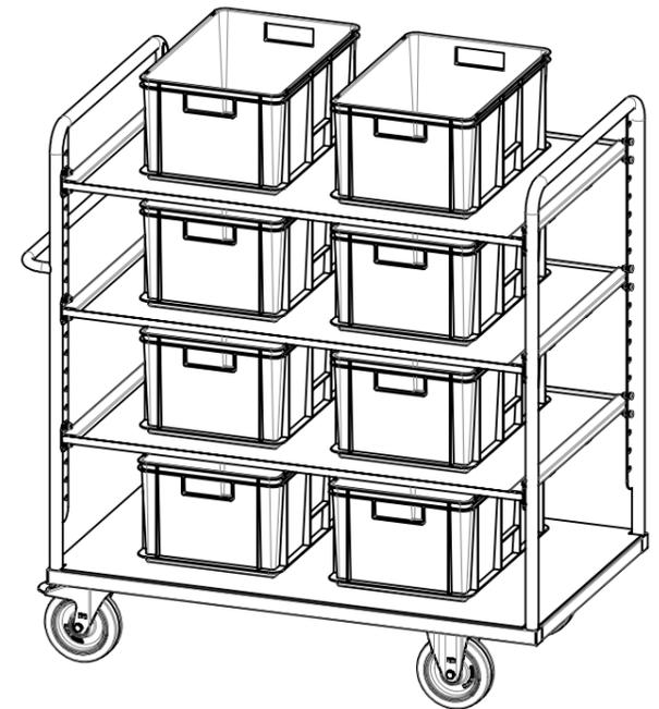
Traglast 1000 kg (pro Einhängboden 200 kg, unterer Boden 500 kg), spurfreie Elastikgummi-Lenkrollen (Kugellagerrad, 2x Bockrollen, 2 Lenkrollen mit Totalfeststeller), verstellbare Einhängböden aus beidseitig filmbeschichteter Multiplexplatte (Raster der Verstellung 50 mm, Schrägstellung bis 15° möglich, Seitenrand 10 mm hoch), kunstharzlackiert RAL 5012 Lichtblau
