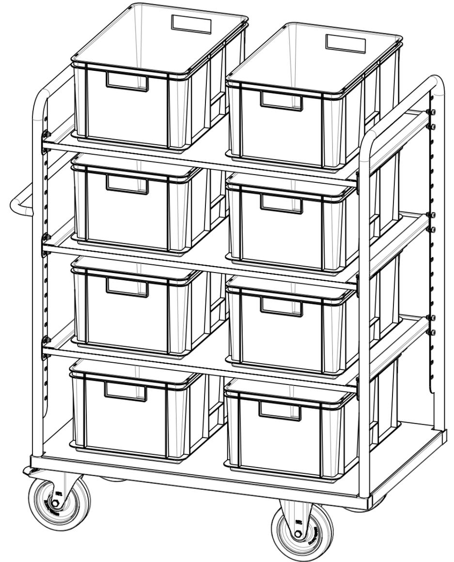
Traglast 1000 kg (pro Einhängboden 200 kg, unterer Boden 500 kg), spurfreie Elastikummi-Lenkrollen (Kugellagerrad, 2x Bockrollen, 2 Lenkrollen mit Totalfeststeller), verstellbare Einhängböden aus beidseitig filmbeschichteter Multiplexplatte (Raster der Verstellung 50 mm, Schrägstellung bis 15° möglich, Seitenrand 10 mm hoch), kunstharzlackiert RAL 5012 Lichtblau
