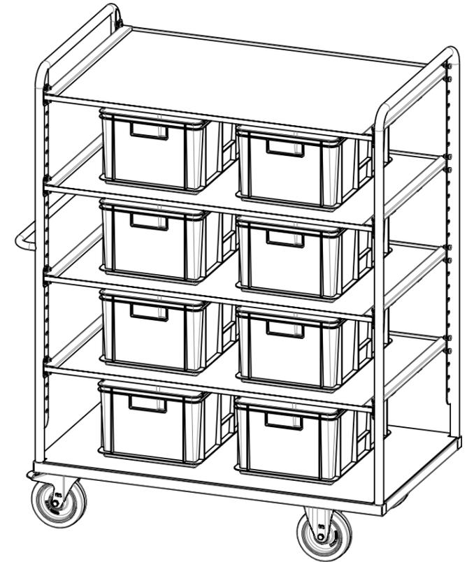
Traglast 1000 kg (pro Einhängboden 200 kg, unterer Boden 500 kg), spurfreie Elastikgummi-Lenkrollen (Kugellagerrad, 2x Bockrollen, 2 Lenkrollen mit Totalfeststeller), verstellbare Einhängböden aus beidseitig filmbeschichteter Multiplexplatte (Raster der Verstellung 50 mm, Schrägstellung bis 15° möglich, Seitenrand 10 mm hoch), kunstharzlackiert RAL 5012 Lichtblau
