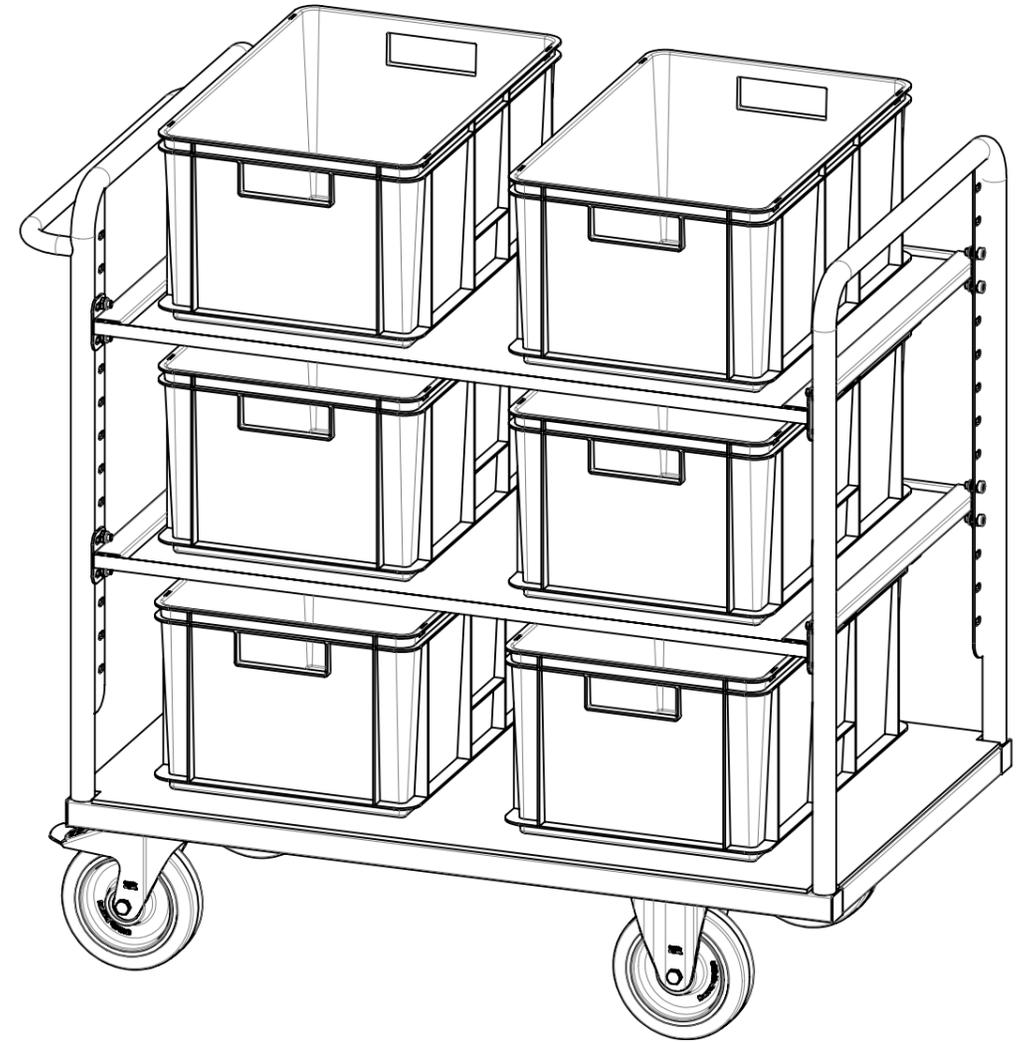
Traglast 1000 kg (pro Einhängboden 200 kg, unterer Boden 500 kg), spurfreie Elastikgummi-Lenkrollen (Kugellagerrad, 2x Bockrollen, 2 Lenkrollen mit Totalfeststeller), verstellbare Einhängböden aus beidseitig filmbeschichteter Multiplexplatte (Raster der Verstellung 50 mm, Schrägstellung bis 15° möglich, Seitenrand 10 mm hoch), kunstharzlackiert RAL 5012 Lichtblau
