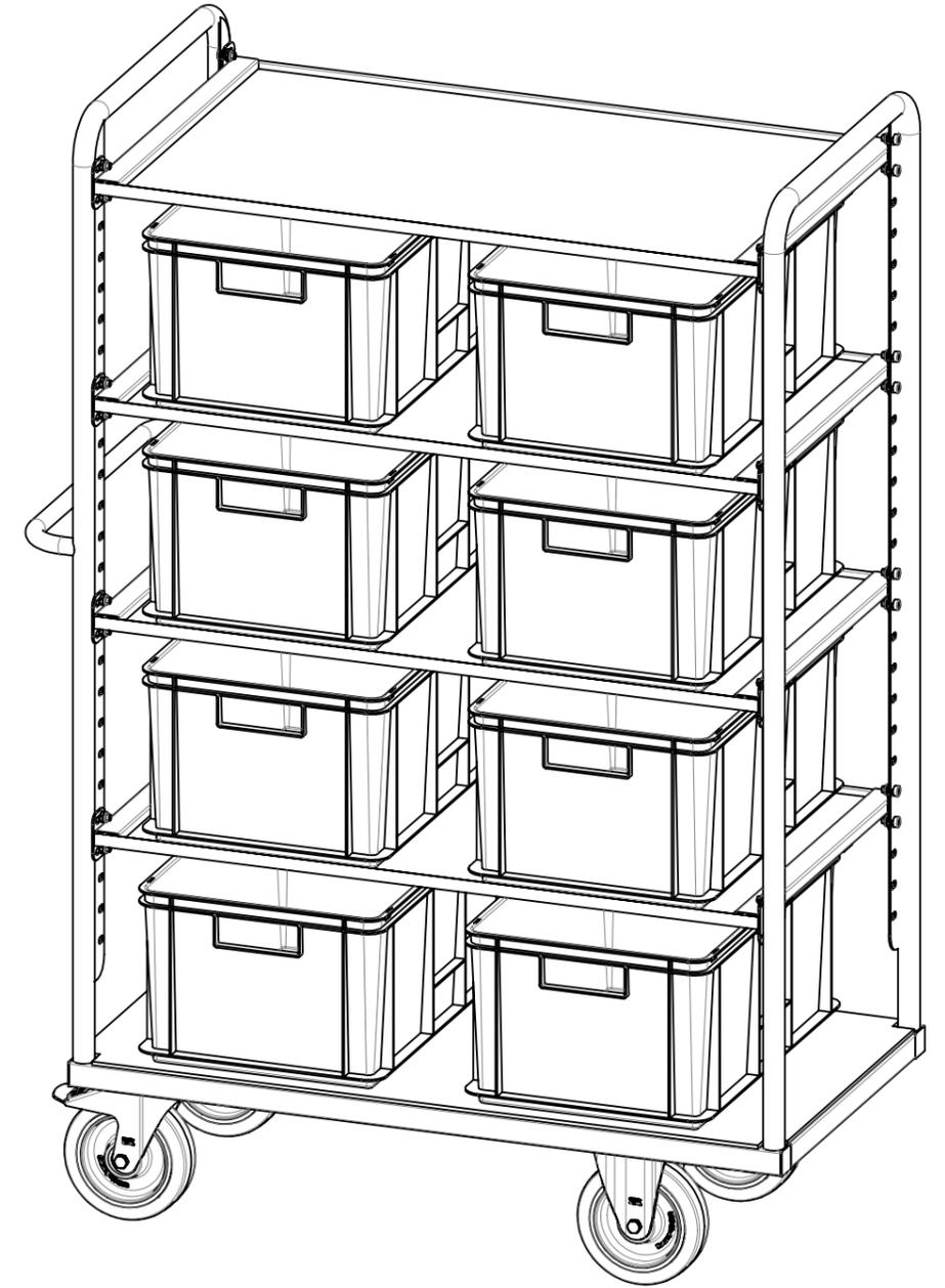
Traglast 1000 kg (pro Einhängboden 200 kg, unterer Boden 500 kg), spurfreie Elastikummi-Lenkrollen (Kugellagerrad, 2x Bockrollen, 2 Lenkrollen mit Totalfeststeller), verstellbare Einhängböden aus beidseitig filmbeschichteter Multiplexplatte (Raster der Verstellung 50 mm, Schrägstellung bis 15° möglich, Seitenrand 10 mm hoch), kunstharzlackiert RAL 5012 Lichtblau
