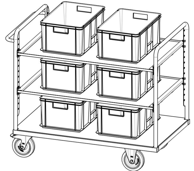
Traglast 1000 kg (pro Einhängboden 200 kg, unterer Boden 500 kg), spurfreie Elastikgummi-Lenkrollen (Kugellagerrad, 2x Bockrollen, 2 Lenkrollen mit Totalfeststeller), verstellbare Einhängböden aus beidseitig filmbeschichteter Multiplexplatte (Raster der Verstellung 50 mm, Schrägstellung bis 15° möglich, Seitenrand 10 mm hoch), kunstharzlackiert RAL 5012 Lichtblau
