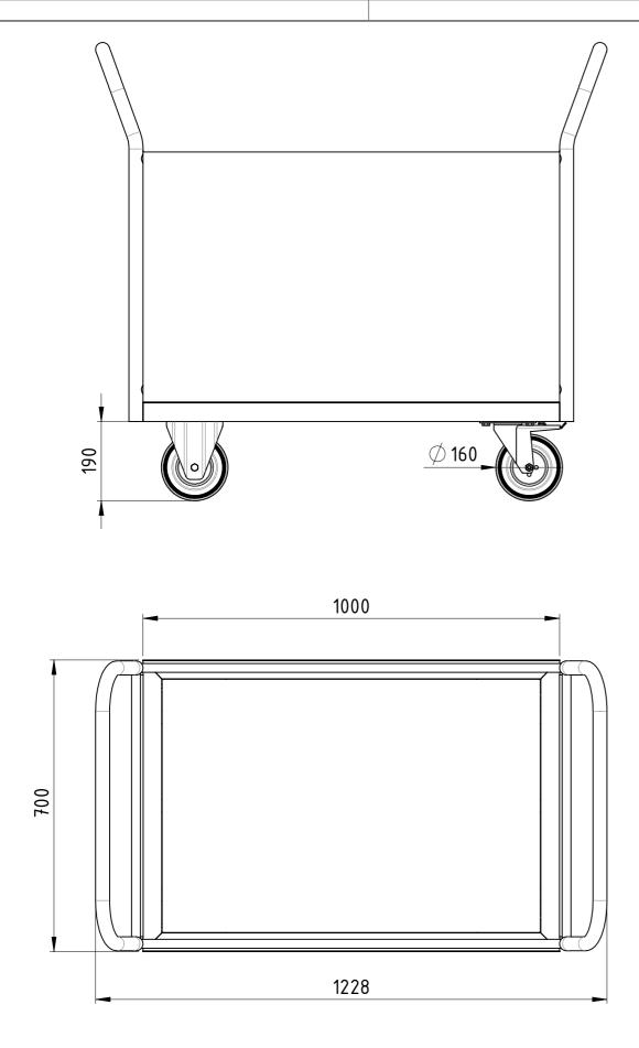
Traglast 500 kg, 4x Vollgummi-Rollen (2x Bockrollen, 2x Lenkrollen mit Totalfeststeller), filmbeschichtete Multiplexplatte, kunstharzlackiert RAL 5012 Lichtblau
