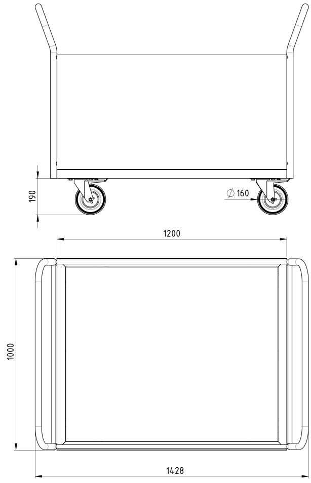
Traglast 500 kg, 4x Vollgummi-Lenkrollen (2x Lenkrollen mit Totalfeststeller), filmbeschichtete Multiplexplatte, kunstharzlackiert RAL 5012 Lichtblau
