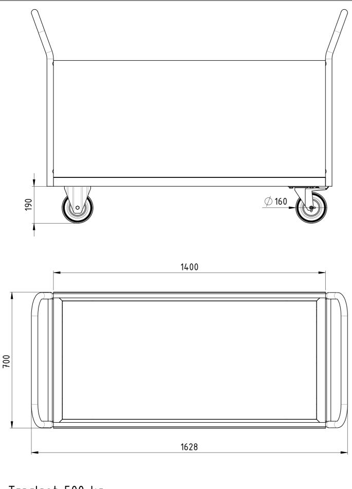
Traglast 500 kg, 4x Vollgummi-Rollen (2x Bockrollen, 2x Lenkrollen mit Totalfeststeller), filmbeschichtete Multiplexplatte, kunstharzlackiert RAL 5012 Lichtblau
