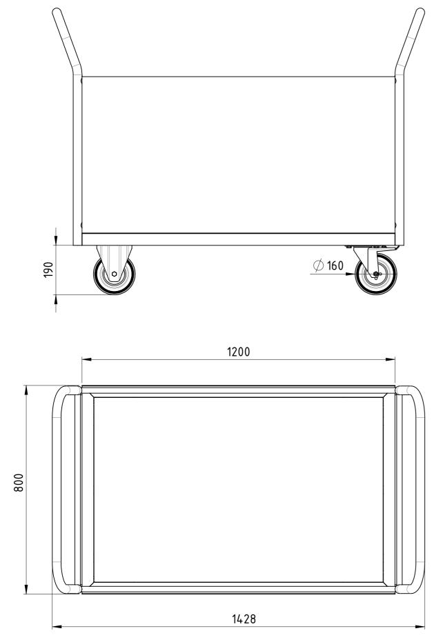
Traglast 500 kg, 4x Vollgummi-Rollen (2x Bockrollen, 2x Lenkrollen mit Totalfeststeller), filmbeschichtete Multiplexplatte, kunstharzlackiert RAL 5012 Lichtblau
