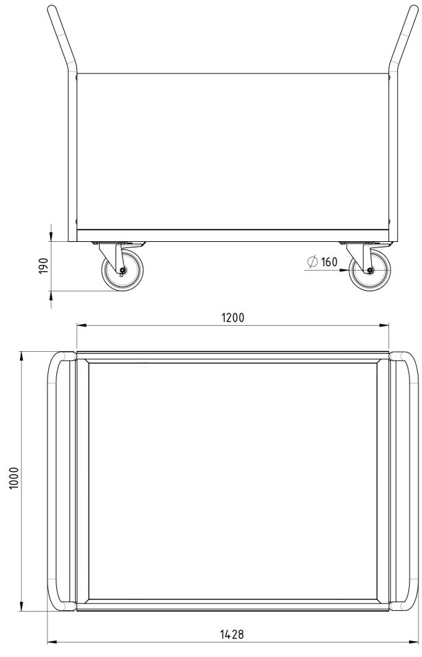
Traglast 1000 kg, 4x Polyurethan-Lenkrollen (2x Lenkrollen mit Totalfeststeller), filmbeschichtete Multiplexplatte, kunstharzlackiert RAL 5012 Lichtblau
