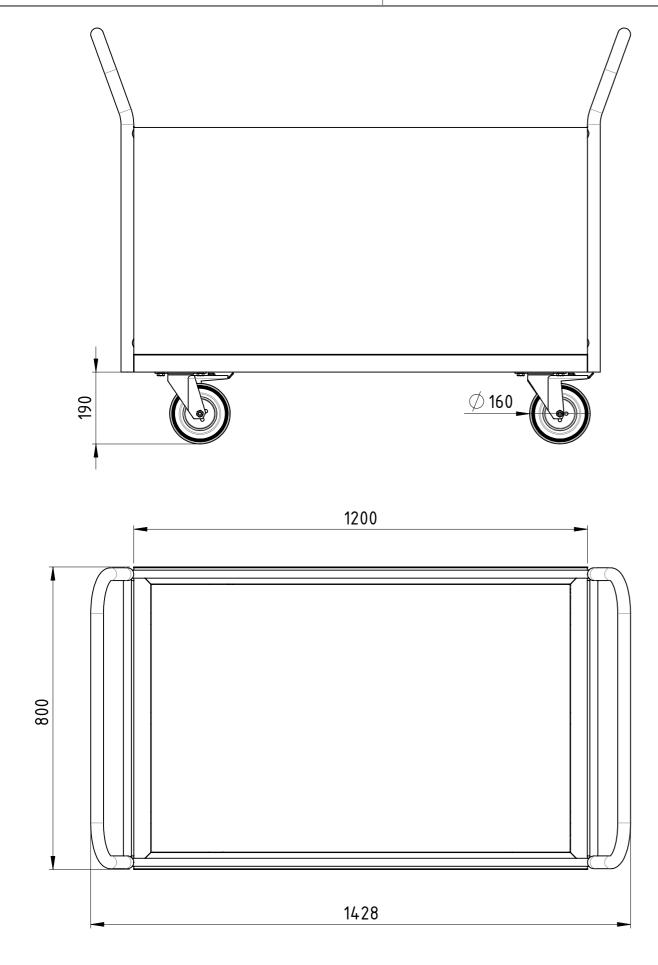
Traglast 500 kg, 4x Vollgummi-Lenkrollen (2x Lenkrollen mit Totalfeststeller), filmbeschichtete Multiplexplatte, kunstharzlackiert RAL 5012 Lichtblau
