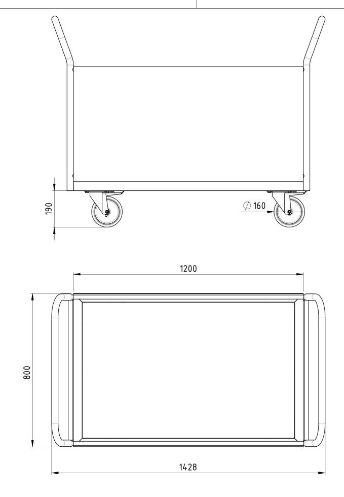
Traglast 1000 kg, 4x Polyurethan-Lenkrollen (2x Lenkrollen mit Totalfeststeller), 15 mm filmbeschichtete Multiplexplatte, kunstharzlackiert RAL 5012 Lichtblau
