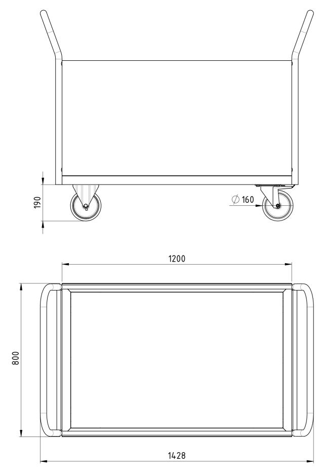
Traglast 1000 kg, 4x Polyurethan-Rollen (2x Bockrollen, 2x Lenkrollen mit Totalfeststeller), filmbeschichtete Multiplexplatte, kunstharzlackiert RAL 5012 Lichtblau
