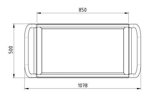
Traglast 1000 kg, 4x Polyurethan-Rollen (2x Bockrollen, 2x Lenkrollen mit Totalfeststeller), 15 mm filmbeschichtete Multiplexplatte, kunstharzlackiert RAL 5012 Lichtblau
