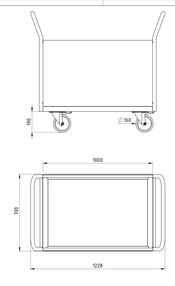
Traglast 1000 kg, 4x Polyurethan-Lenkrollen (2x Lenkrollen mit Totalfeststeller), filmbeschichtete Multiplexplatte, kunstharzlackiert RAL 5012 Lichtblau
