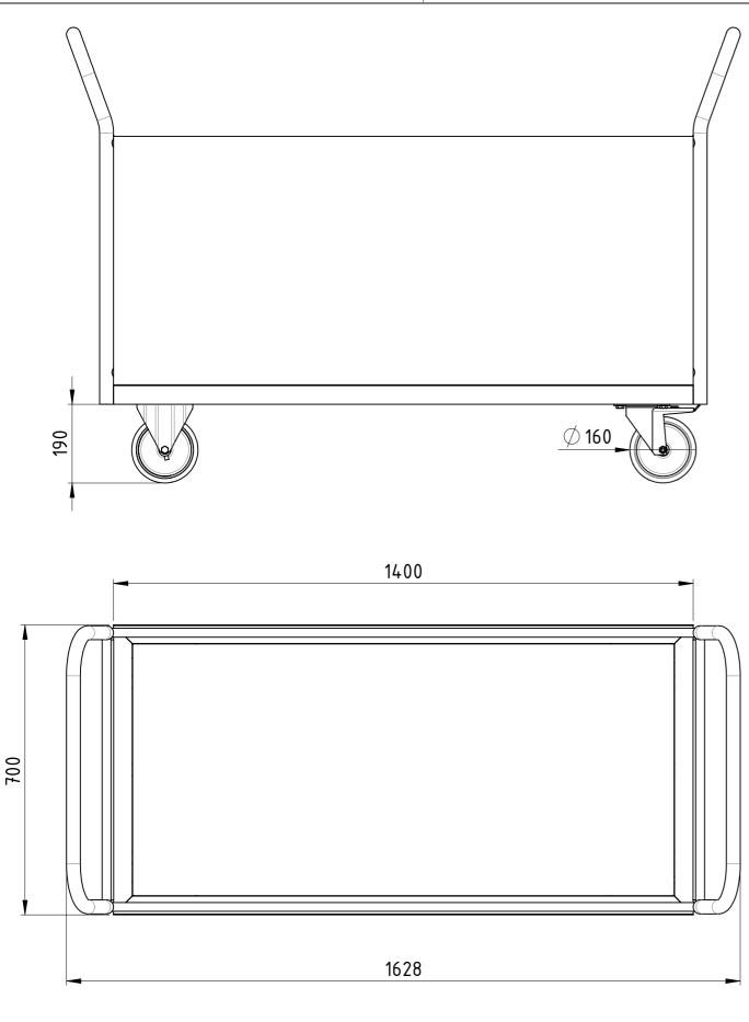
Traglast 1000 kg, 4x Polyurethan-Rollen (2x Bockrollen, 2x Lenkrollen mit Totalfeststeller), filmbeschichtete Multiplexplatte, kunstharzlackiert RAL 5012 Lichtblau
