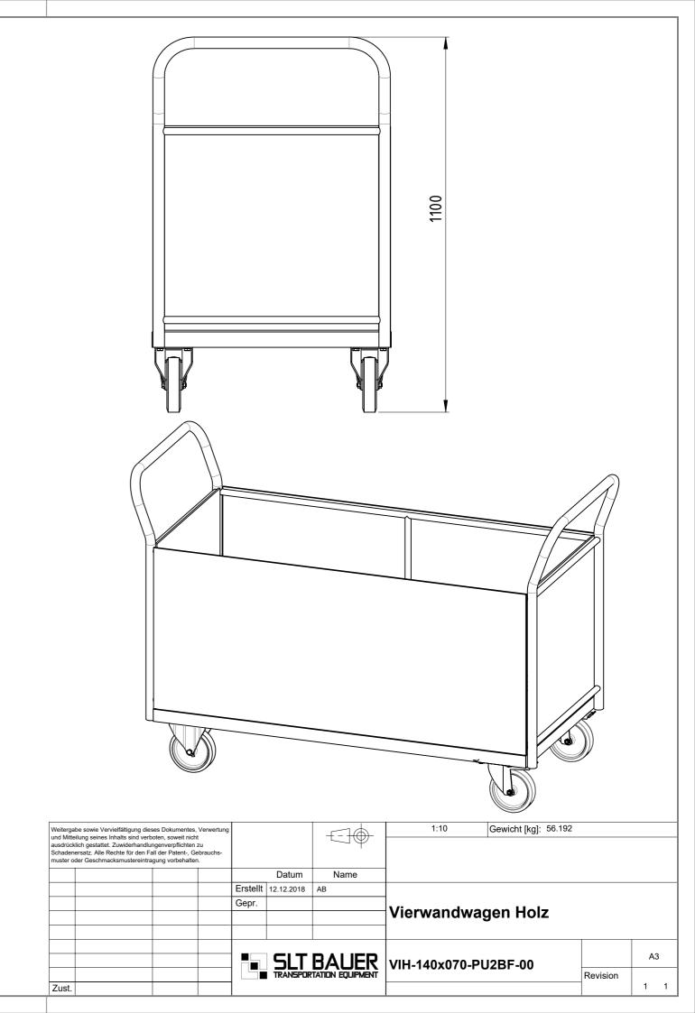
Traglast 1000 kg, 4x Polyurethan-Lenkrollen (2x Lenkrollen mit Totalfeststeller), filmbeschichtete Multiplexplatte, kunstharzlackiert RAL 5012 Lichtblau
