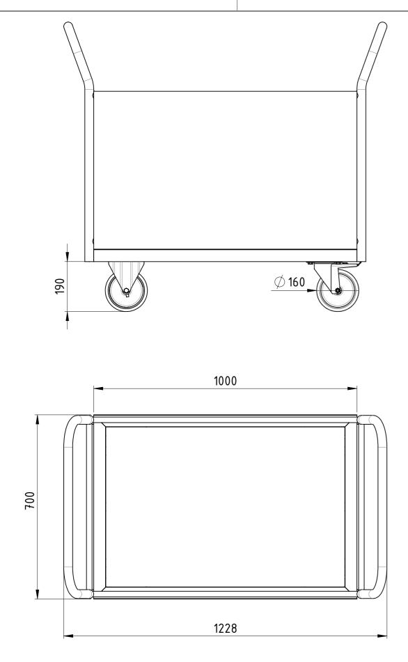
Traglast 1000 kg, 4x Polyurethan-Rollen (2x Bockrollen, 2x Lenkrollen mit Totalfeststeller), filmbeschichtete Multiplexplatte, kunstharzlackiert RAL 5012 Lichtblau
