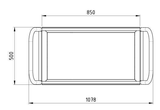
Traglast 1000 kg, 4x Polyurethan-Lenkrollen (2x Lenkrollen mit Totalfeststeller), 15 mm filmbeschichtete Multiplexplatte, kunstharzlackiert RAL 5012 Lichtblau
