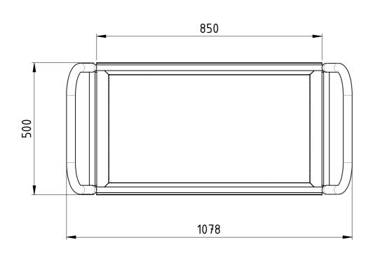
Traglast 500 kg, 4x Vollgummi-Rollen (2x Bockrollen, 2x Lenkrollen mit Totalfeststeller), 15 mm filmbeschichtete Multiplexplatte, kunstharzlackiert RAL 5012 Lichtblau
