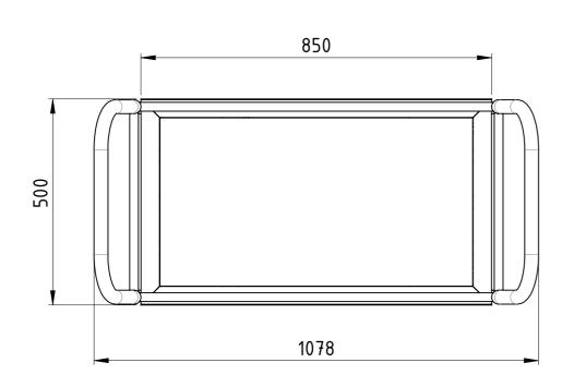
Traglast 500 kg, 4x Vollgummi-Lenkrollen (2x Lenkrollen mit Totalfeststeller), 15 mm filmbeschichtete Multiplexplatte, kunstharzlackiert RAL 5012 Lichtblau
