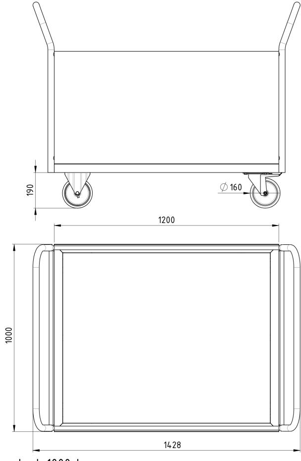
Traglast 1000 kg, 4x Polyurethan-Rollen (2x Bockrollen, 2x Lenkrollen mit Totalfeststeller), filmbeschichtete Multiplexplatte, kunstharzlackiert RAL 5012 Lichtblau
