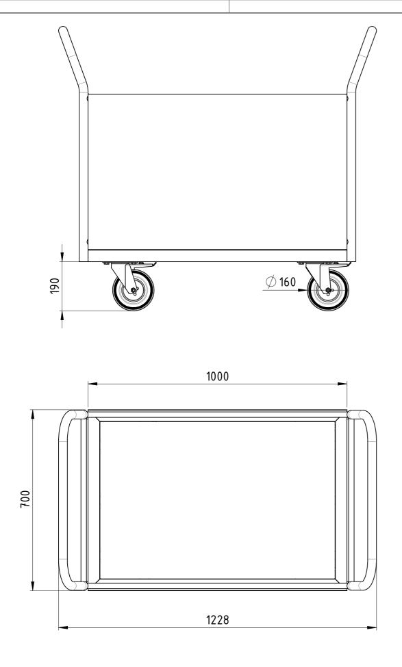
Traglast 500 kg, 4x Vollgummi-Lenkrollen (2x Lenkrollen mit Totalfeststeller), filmbeschichtete Multiplexplatte, kunstharzlackiert RAL 5012 Lichtblau
